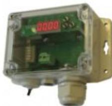
Стационарный газосигнализатор **Астра-СВ** предназначен для непрерывного автоматического измерения концентрации аммиака (NH<sub>3</sub>) и выдачи светового и звукового сигналов при достижении порогового уровня концентрации, а также выдачи сигналов управления внешними устройствами путем включения реле (при заказе выносного блока силовых реле). Газосигнализатор **Астра-СВ** имеет индикацию концентраций газов на цифровом светодиодном индикаторе.
