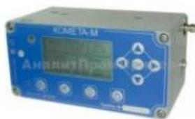
**Газоанализатор переносной КОМЕТА-М** предназначен для мониторинга воздуха рабочей зоны посредством измерения и цифровой индикации содержания кислорода, токсичных, горючих и вредных газов с выдачей светового и звукового сигналов при достижении порогового уровня концентрации.
