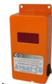
**Газосигнализатор стационарный Дукат-СВ** предназначен для непрерывного автоматического измерения концентрации диоксида углерода CO<sub>2</sub>. Диапазон измерения в зависимости от используемого сенсора: 0 — 5 % или 0 — 100 %. Порог срабатывания по умолчанию один 0,5 %. Сухие контакты реле, коммутируемый ток до 5 А. Используемые сенсоры: MSH-P-CO<sub>2</sub>/NC/5/V/P/F 0 — 5 % или MSH-P-HCO<sub>2</sub>/NC/5/V/P/F 0 — 100 %.
