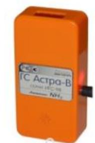
Газоанализатор переносной **Астра-В** предназначен для непрерывного автоматического измерения концентрации **аммиака NH<sub>3</sub>**. Диапазон измерения аммиака 0 — 300 мг/м<sup>3</sup>. Пороги срабатывания по умолчанию 20 мг/м<sup>3</sup> и 60 мг/м<sup>3</sup>.
